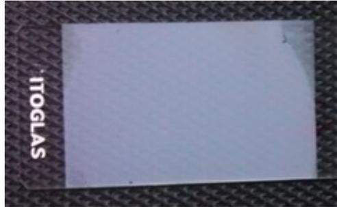
图 3-5 三维多孔纳米结构 ZnO 材料照片（三维多孔纳米结构 Pt/ZnO 复合材料照片与此基本类似）
