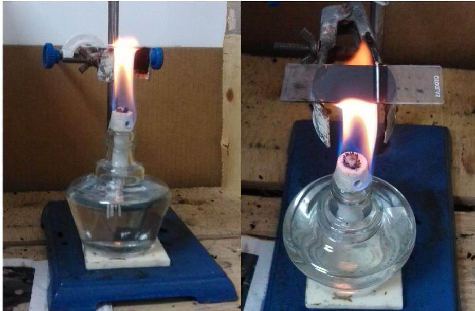
图 3-2 酒精灯火焰法合成碳纳米颗粒的实验装置照片
